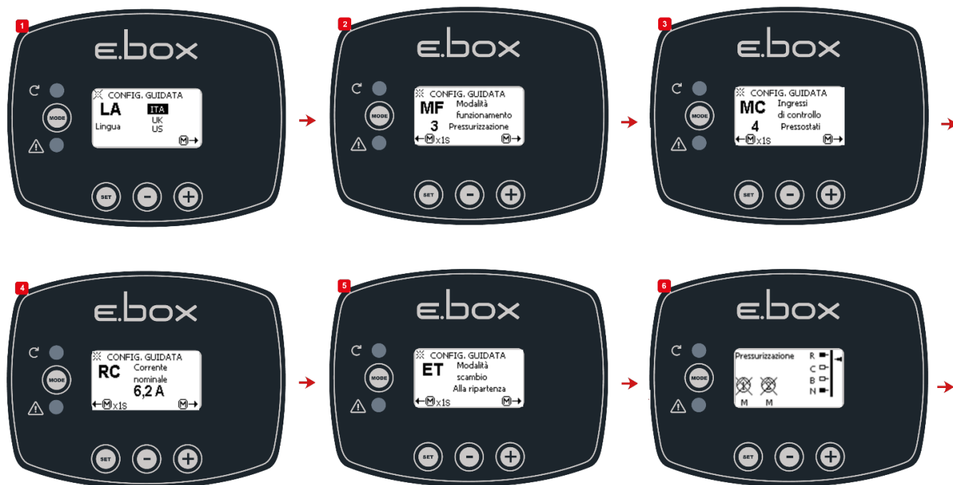
Figure 13 : Fonctionnement avec des pressostats
