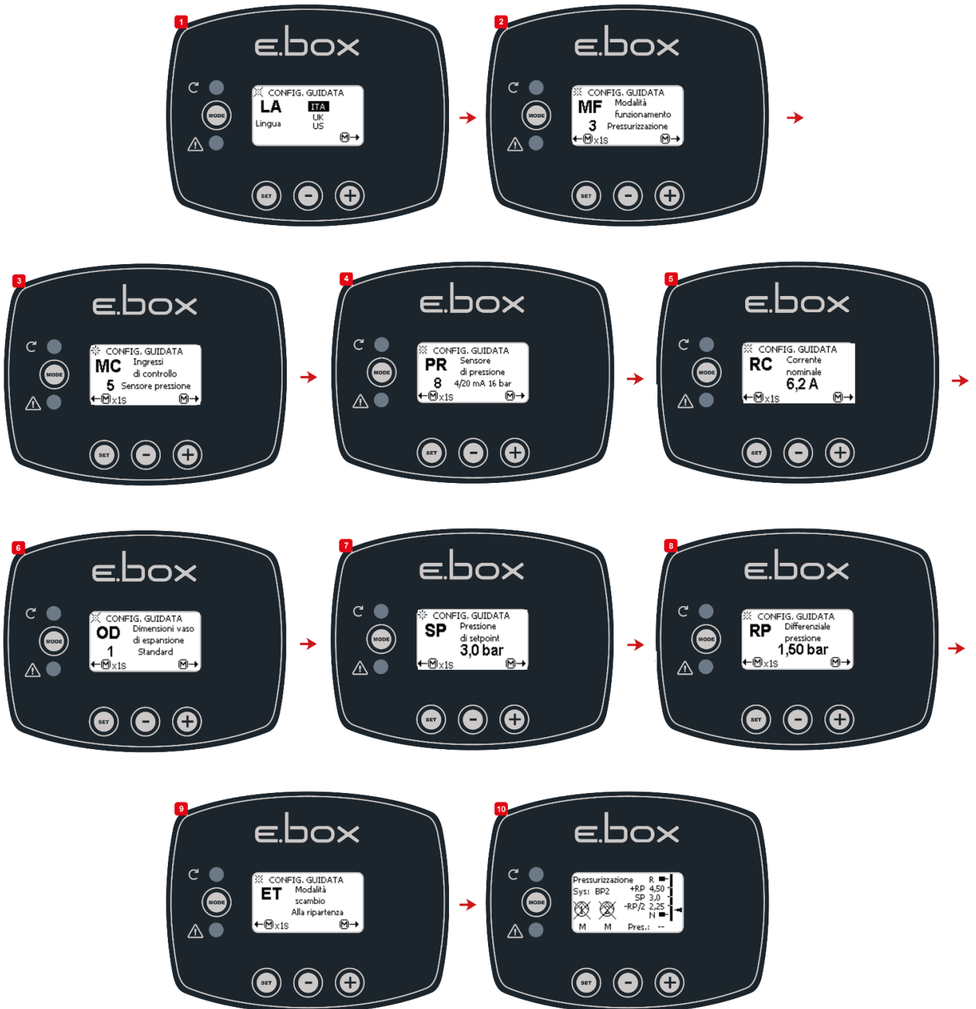
Figura 12: Configurazione con Sensore di pressione
