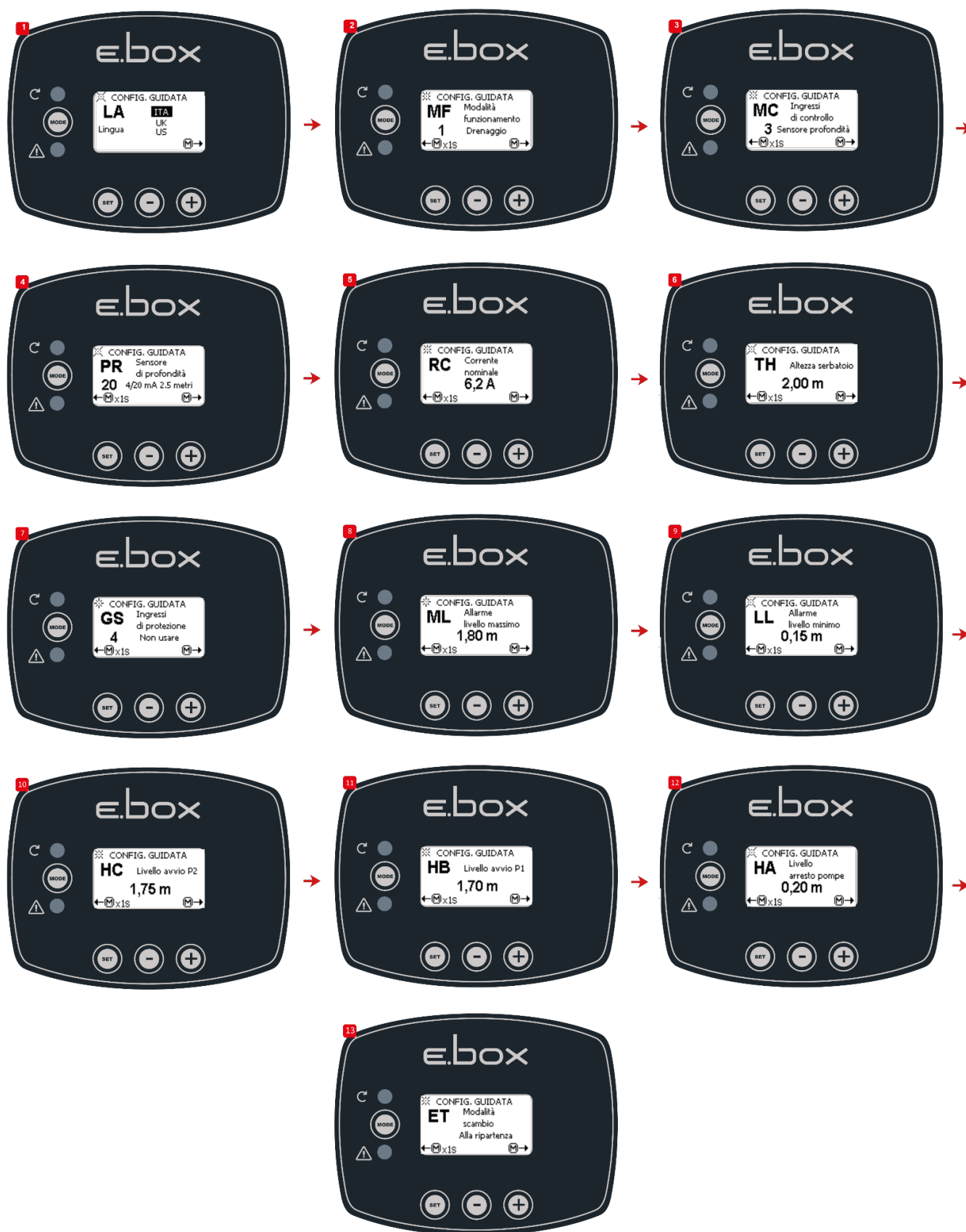
Rysunek 38: Konfiguracja tylko z czujnikiem głębokości
