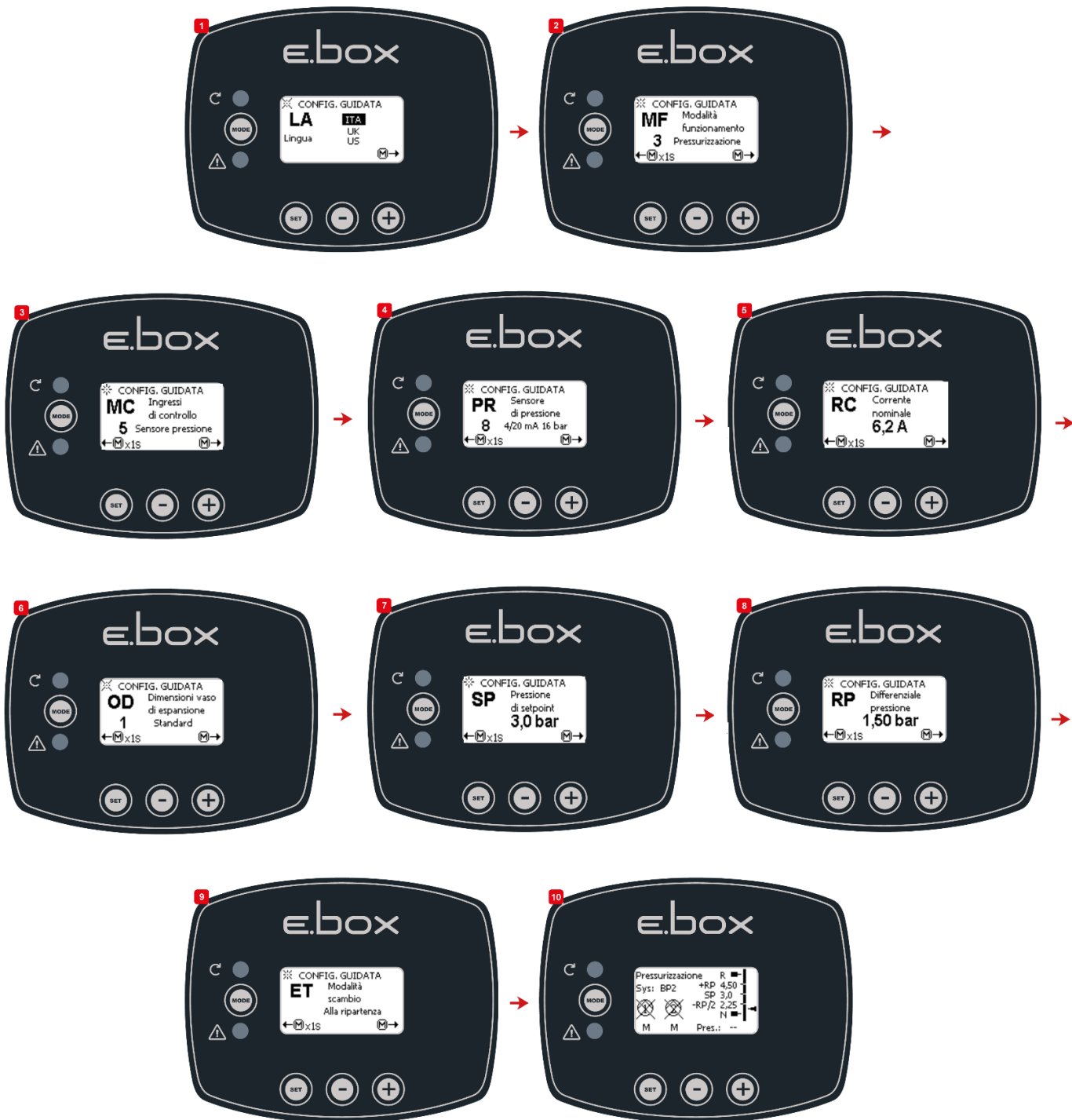
Схема 12: Конфігурація з датчиком тиску
