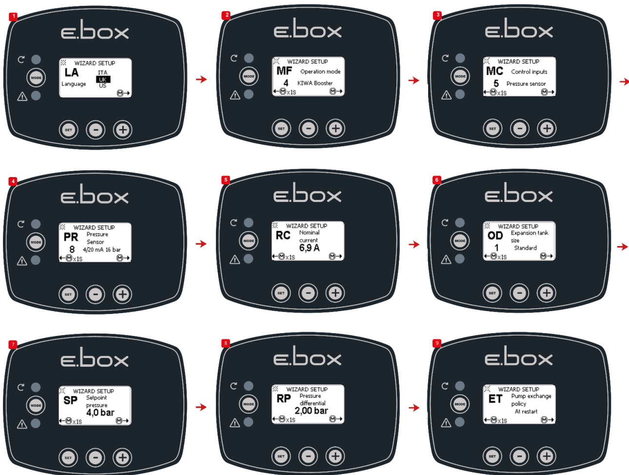
Obrázek 48: KIWA posilování tlaku s tlakovým čidlem
