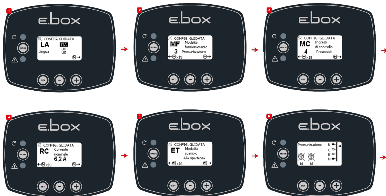
Figura 13: Configurazione con Pressostati
