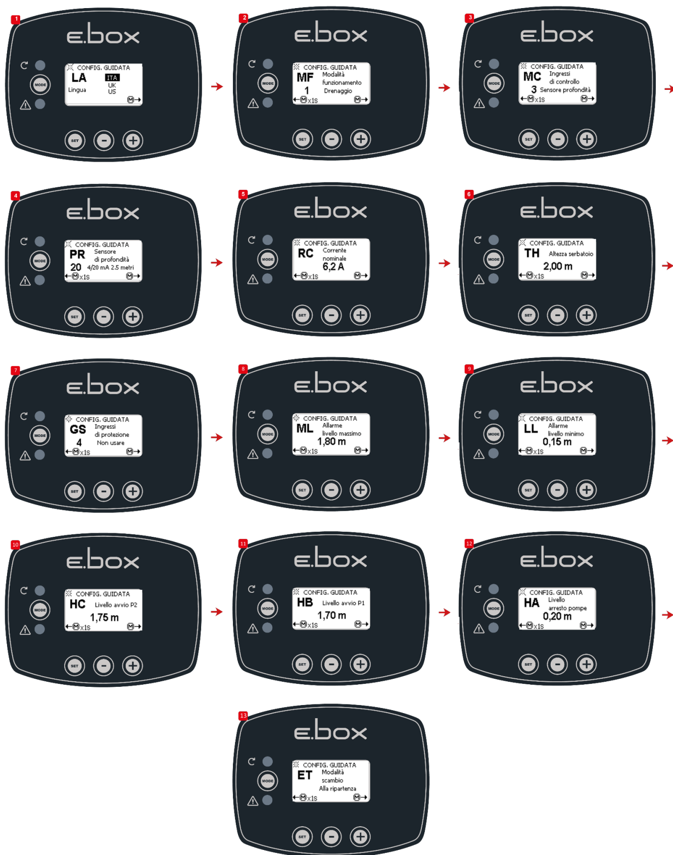
Схема 38: Конфігурація тільки з датчиком глибини
