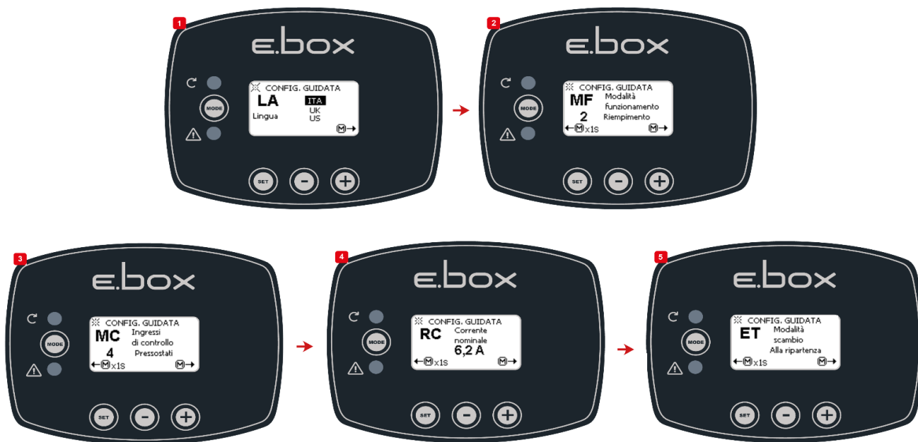
Схема 24: Конфігурація наповнення з поплавками чи датчиками рівня
