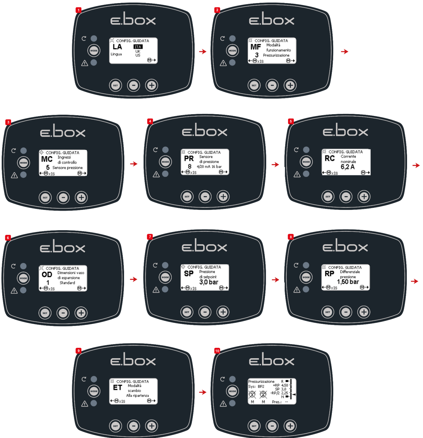
Abbildung 12: Konfiguration mit Drucksensor
