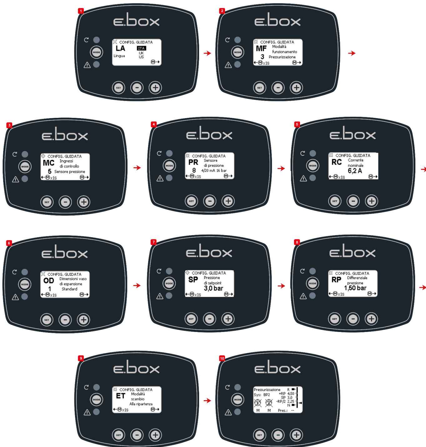
Rysunek 12: Ustawianie za pomocą czujnika ciśnienia
