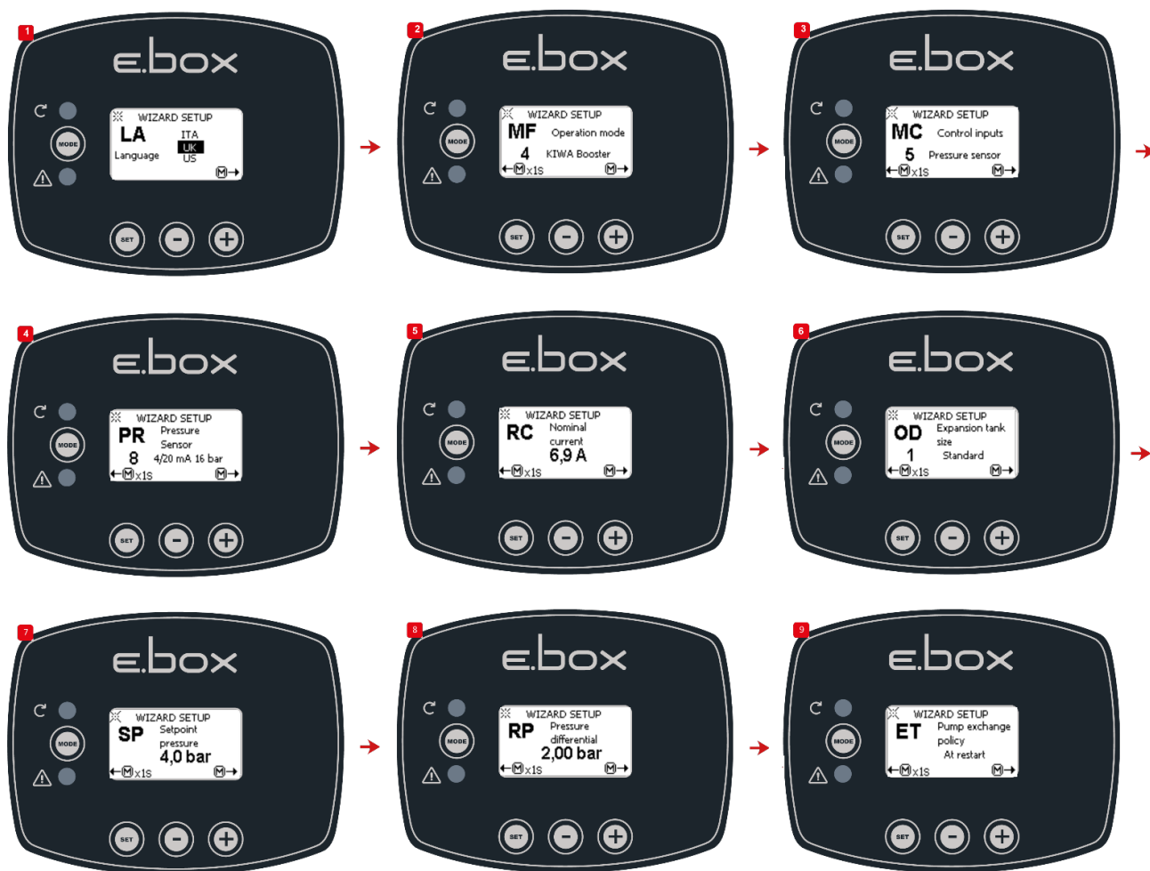
Figura 48: Pressurizzazione KIWA con sensore di pressione
