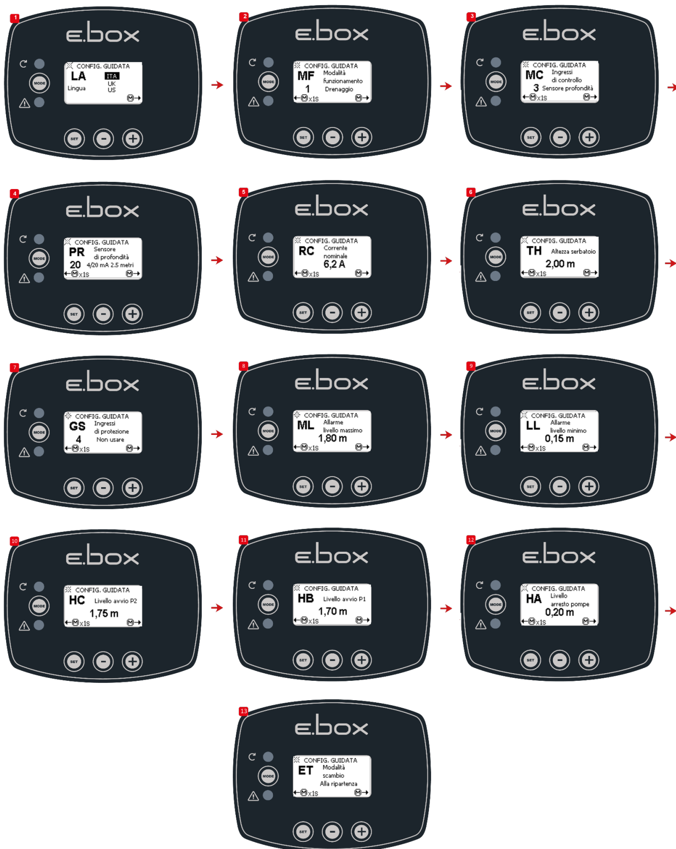
Obrázek 38: Nastavení pouze s hloubkovým čidlem
