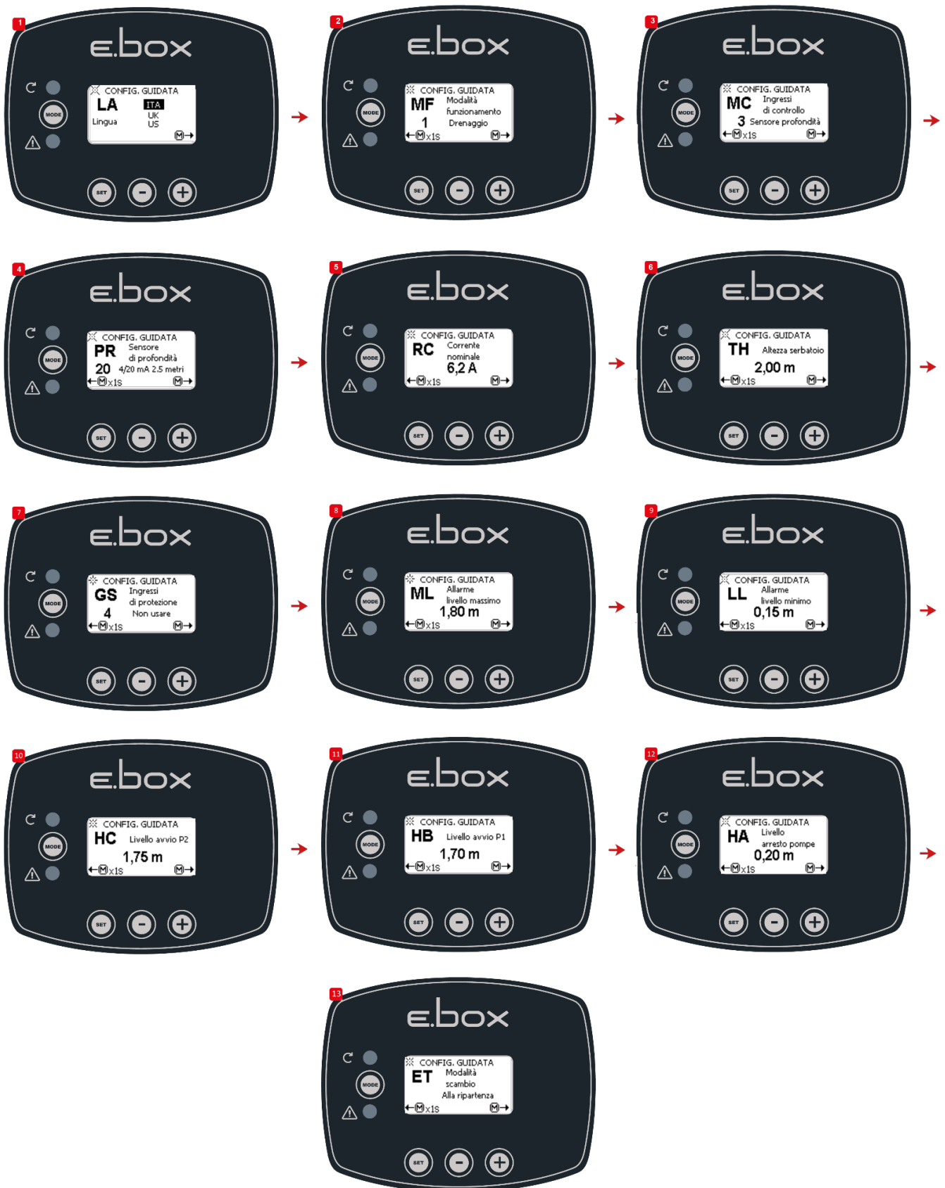
Εικόνα 38: Διαμόρφωση με μόνο αισθητήρα βάθους
