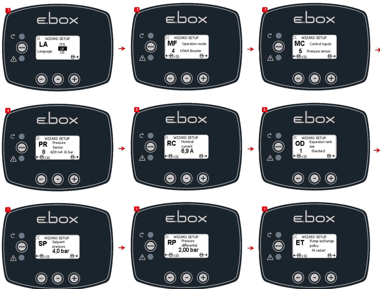
Rysunek 48: Zwiększanie ciśnienia KIWA za pomocą czujnika ciśnienia
