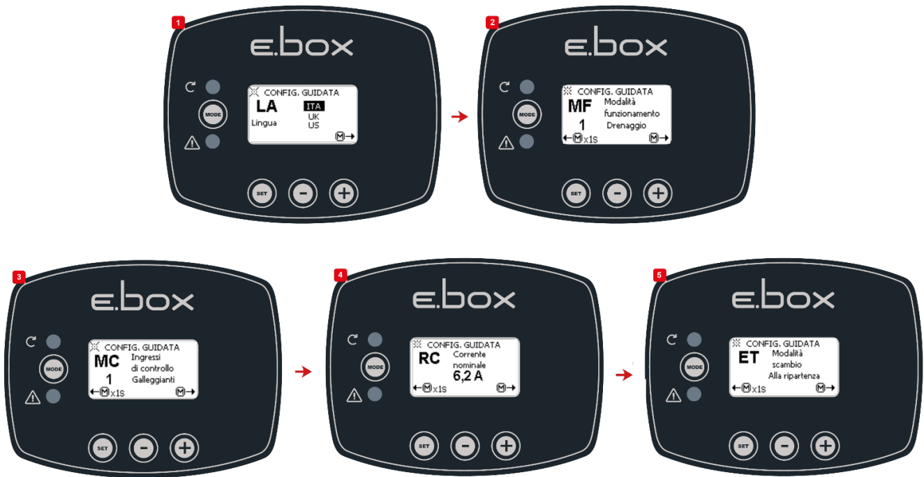
Figura 36: Configurazione Drenaggio galleggianti o sonde di livello
