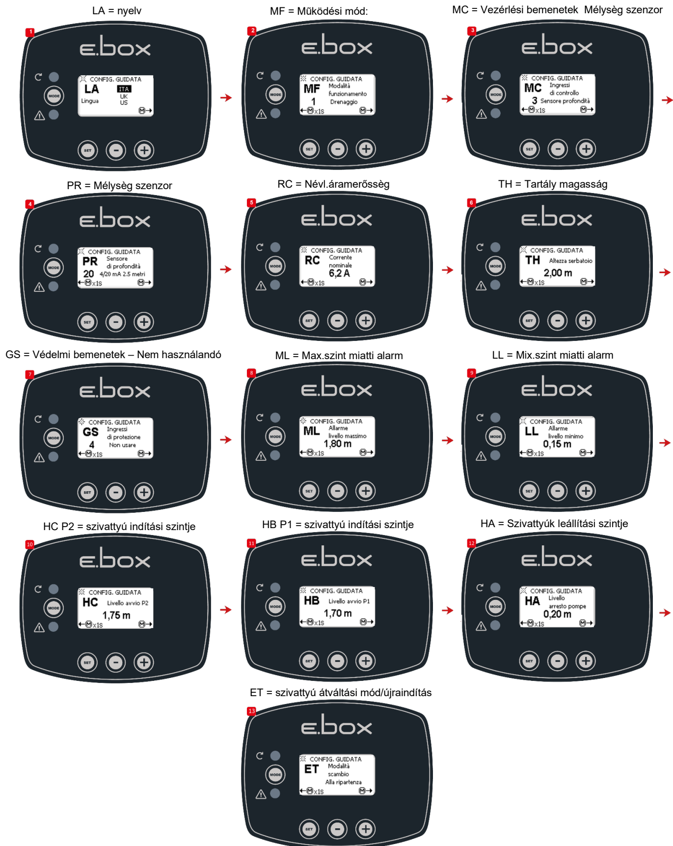
38.ábra: Konfiguráció egyetlen mélység szenzorral
