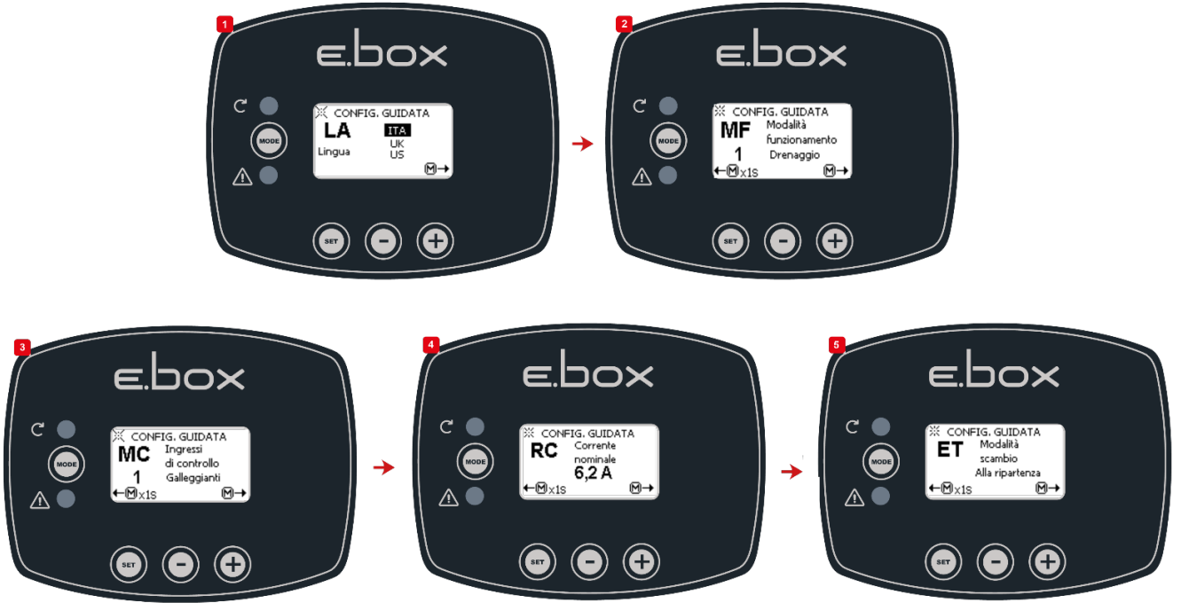
الشكل 36: تهيئة تصريف المُبادلات الكهربائية العامة أو مجسات المستوى
