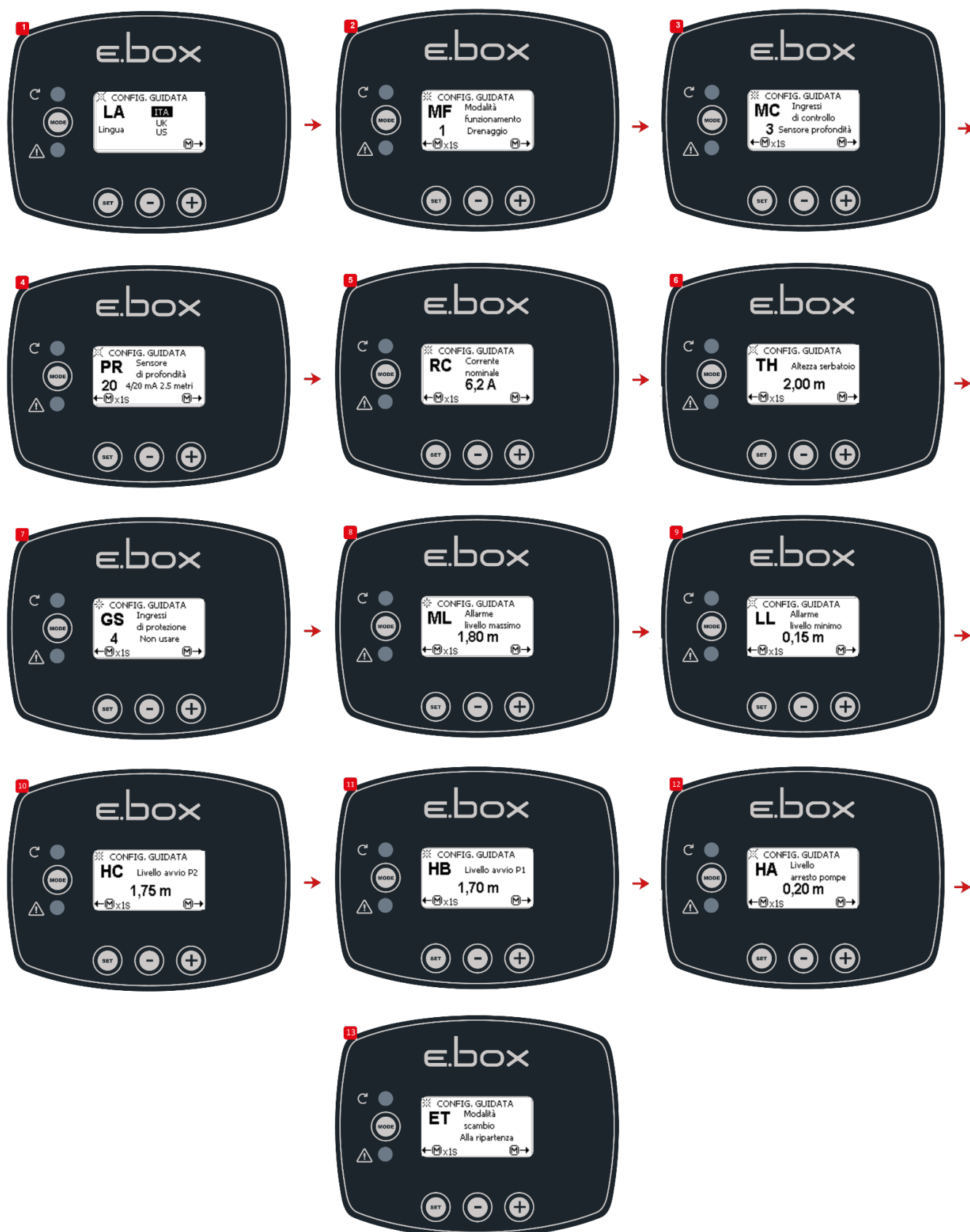
Схема 38: Конфигурация только с датчиком глубины
