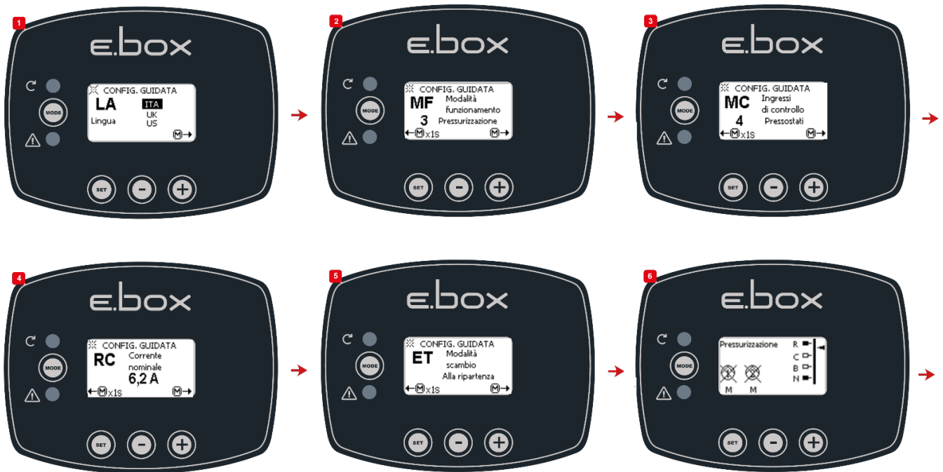
Abbildung 13: Konfiguration mit Druckwächtern
