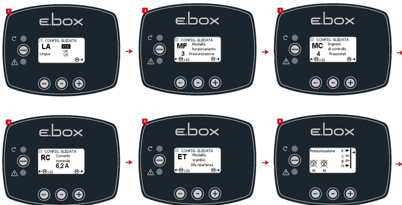
Figura 13: Configurare cu Presostați
