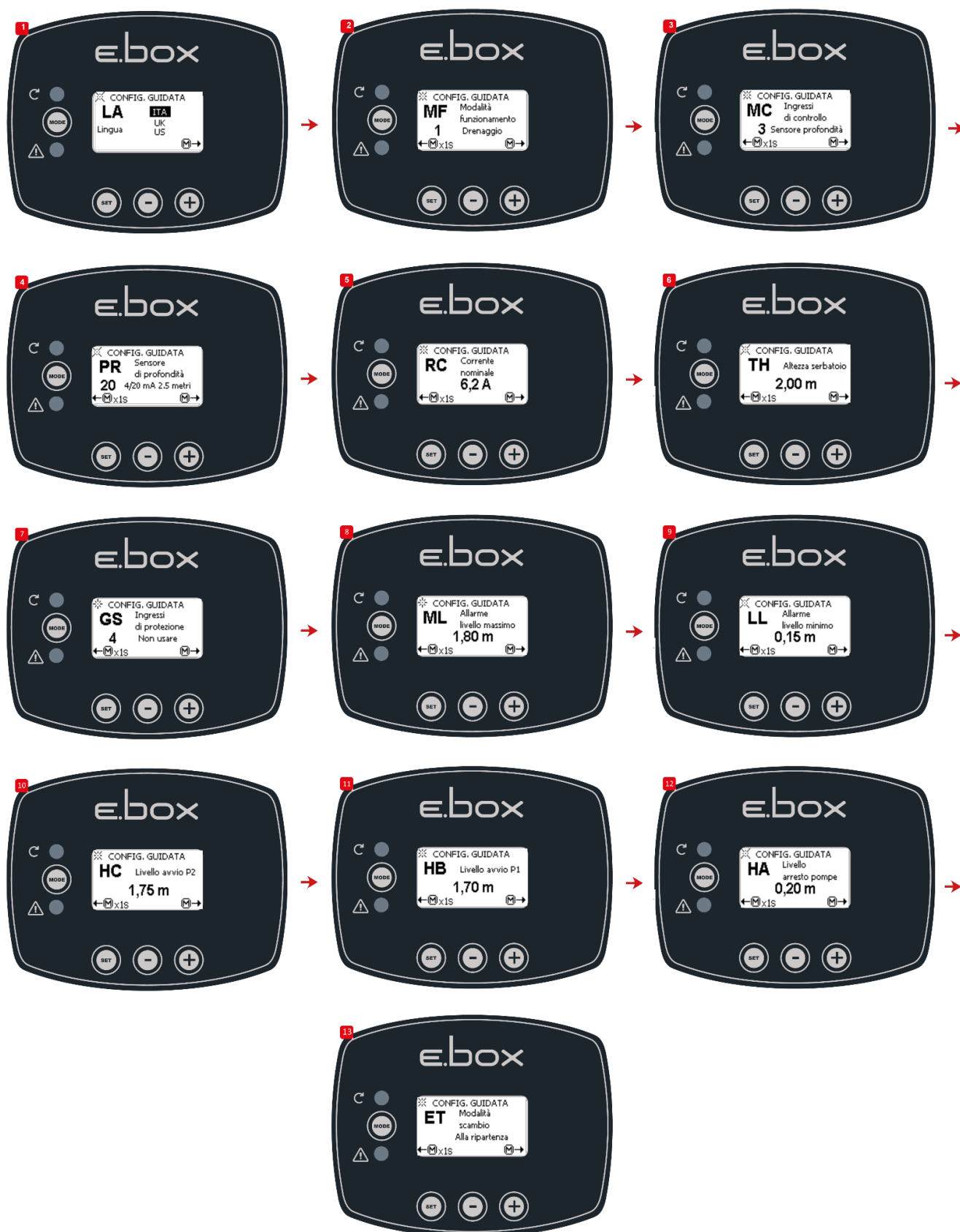
Kuva 38. Määrittys vain yhdellä syvyyssanturilla
