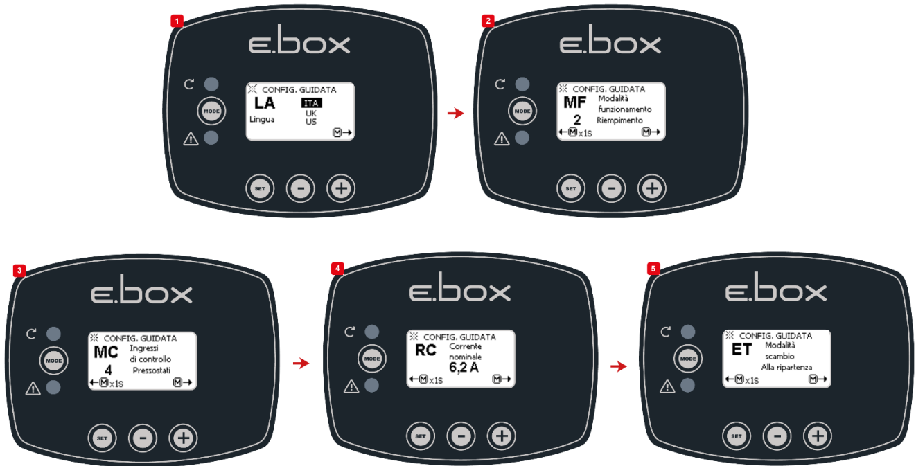
Obrázek 24: Nastavení plnění pomocí plováků nebo hladinových čidel
