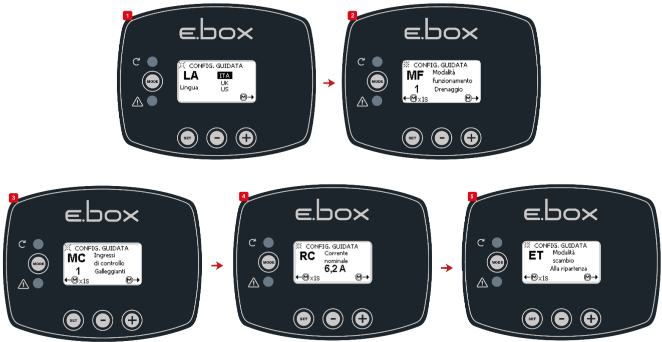
Obrázek 36: Nastavení vypouštění pomocí plováků nebo hladinových čidel
