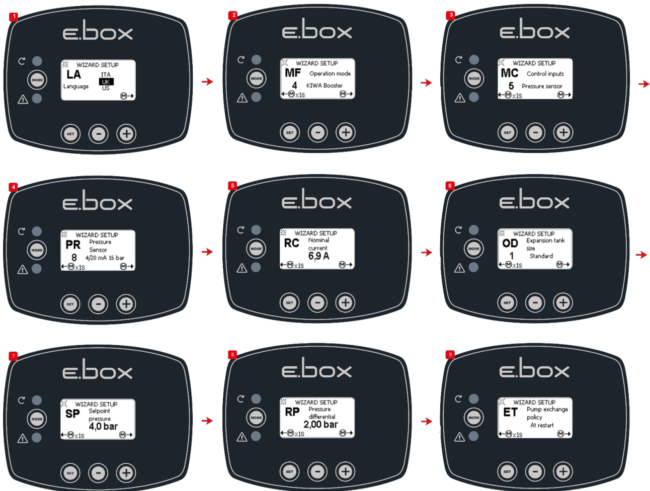
Схема 48: Підвищення тиску KIWA з датчиком тиску
