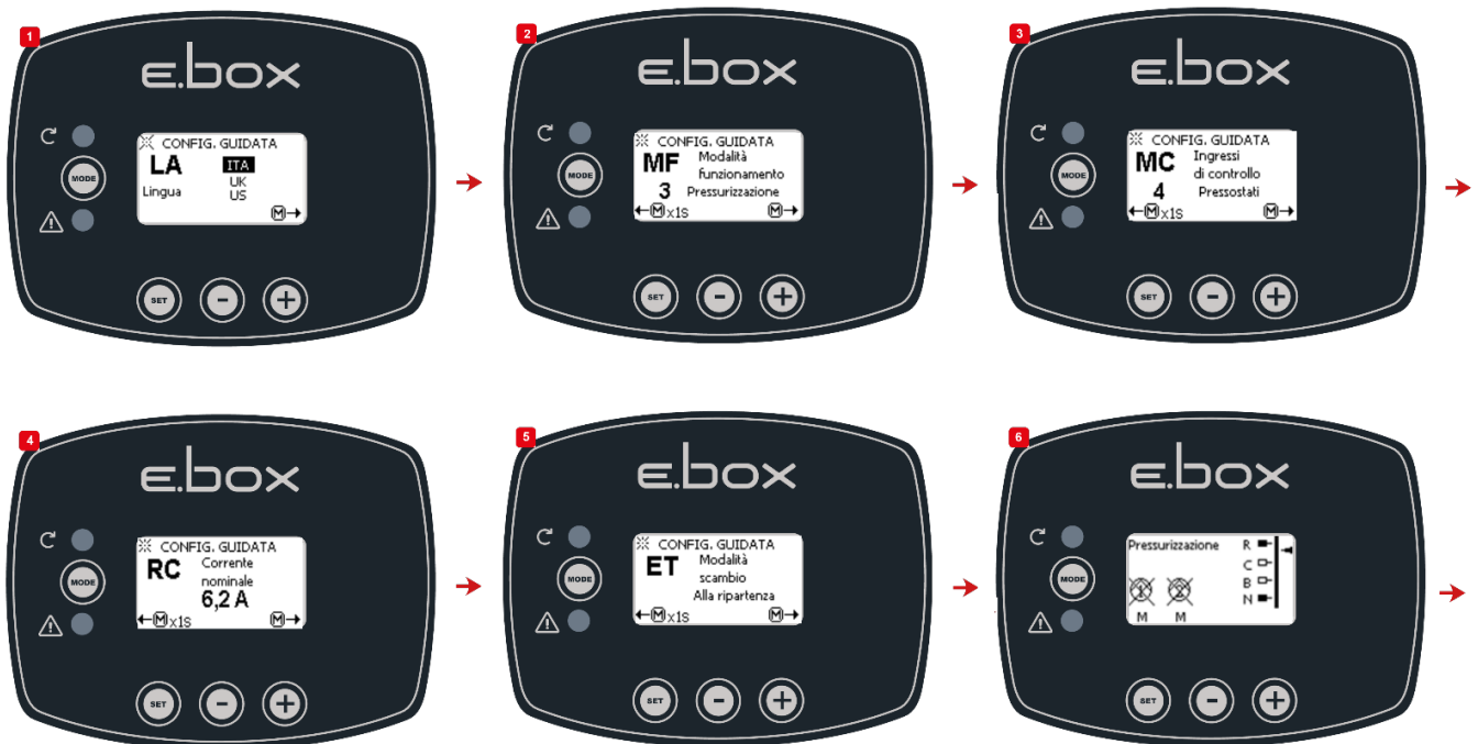
Afbeelding 13: Configuratie met drukschakelaars
