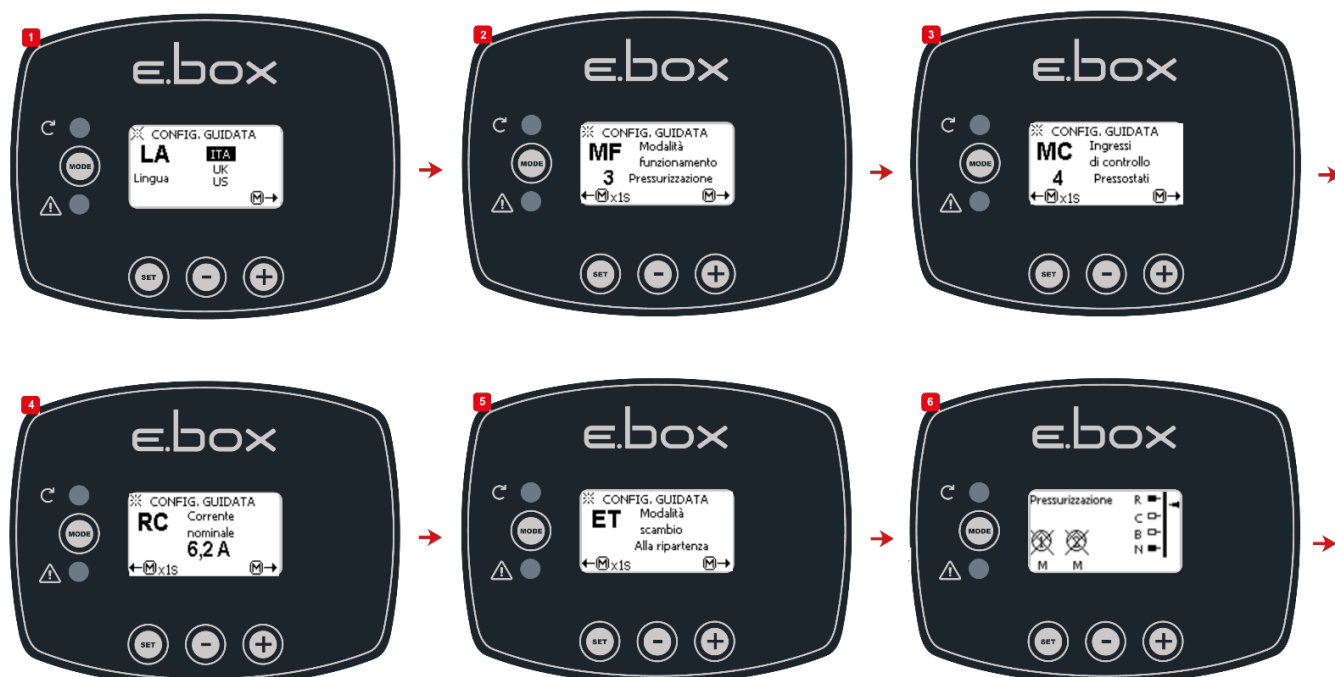
Схема 13: Конфигурация с реле давления
