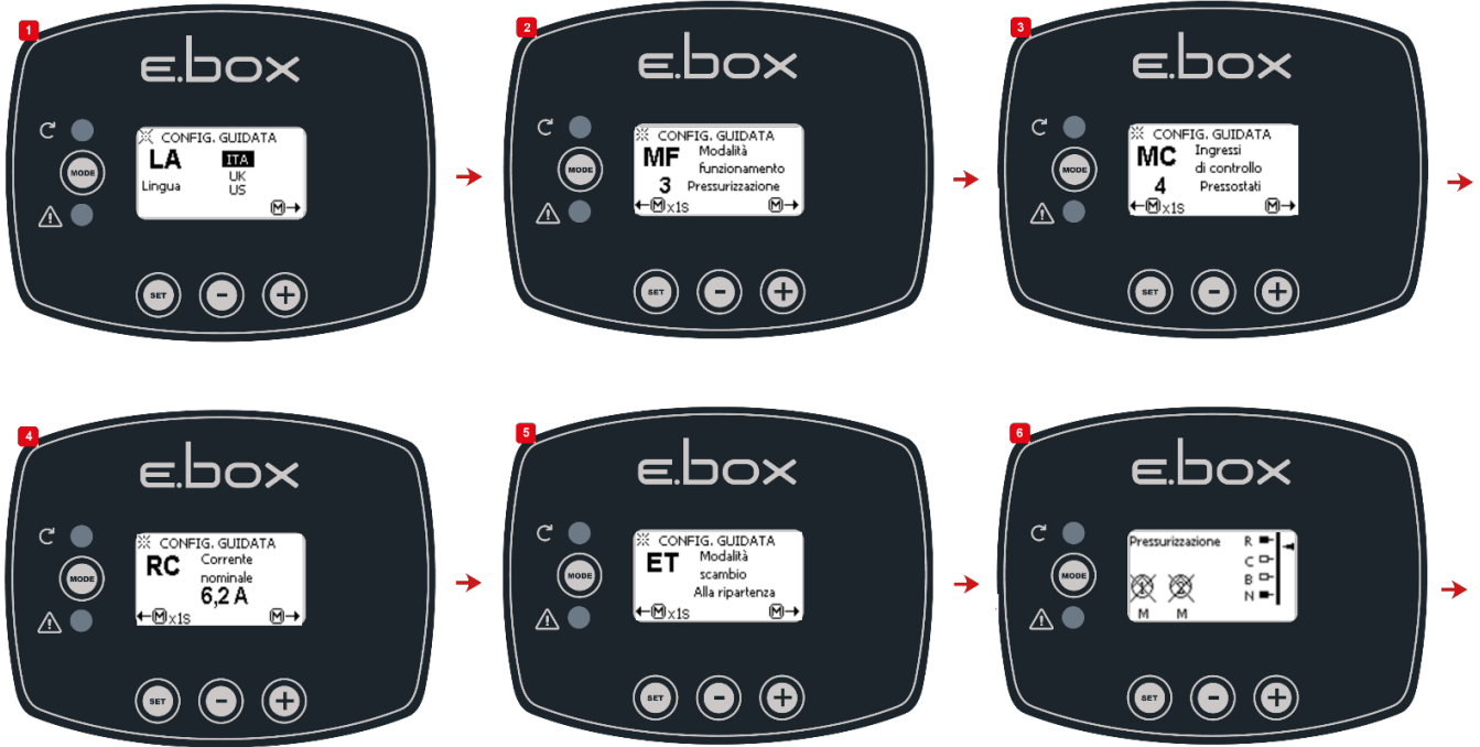
الشكل 13: التهينة باستخدام مفاتيح الضغط
