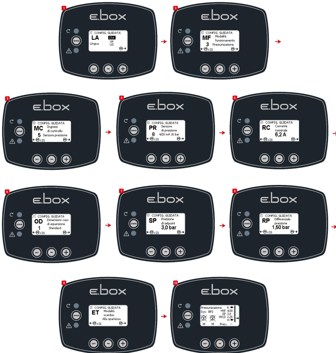
Εικόνα 12: Διαμόρφωση με Αισθητήρα πίεσης
