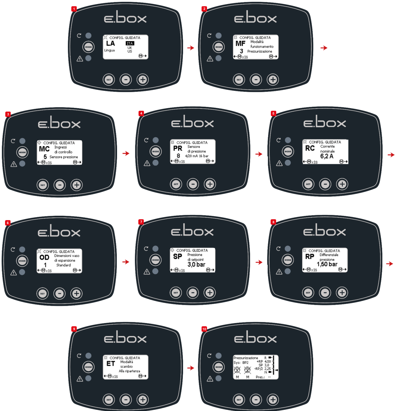
Figure 12 : Configuration avec capteur de pression
