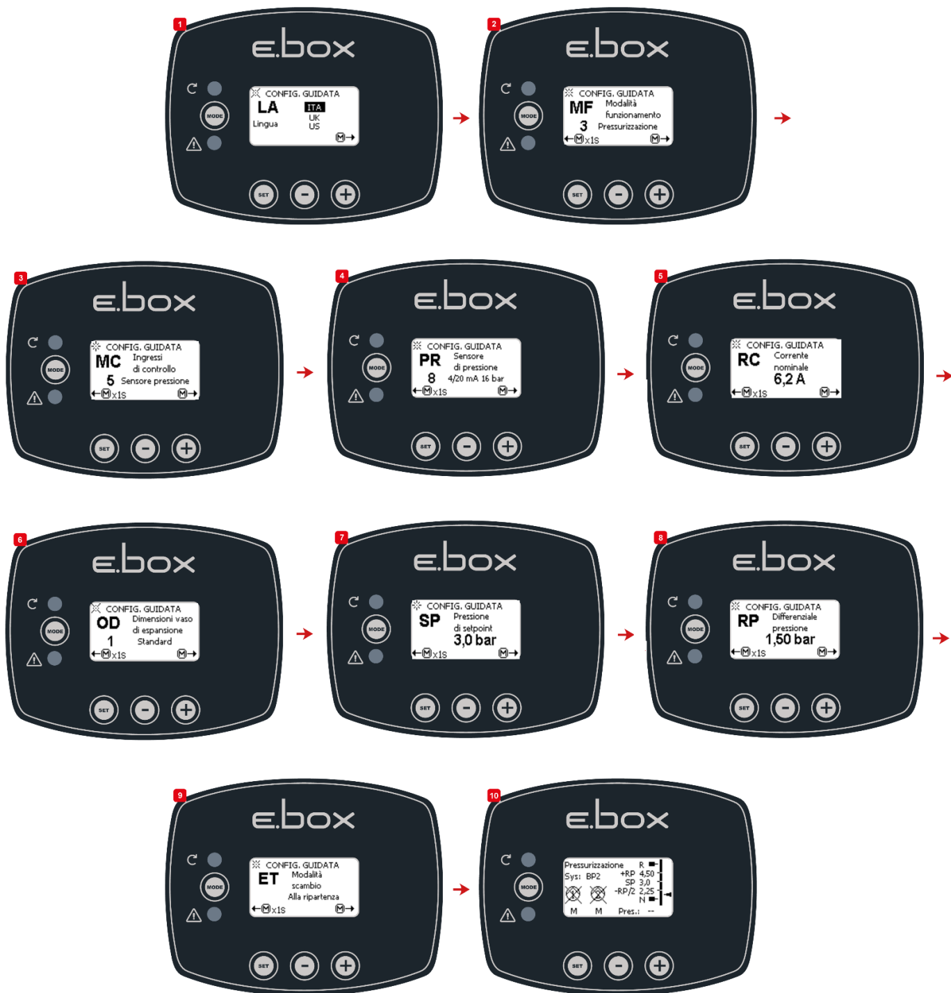
Схема 12: Конфигурация с датчиком давления
