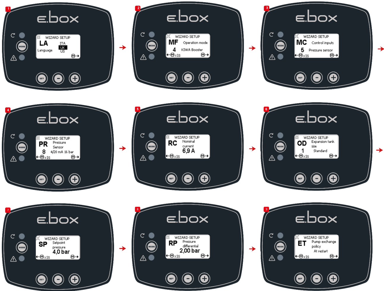
Afbeelding 48: Drukopbouw KIWA met druksensor
