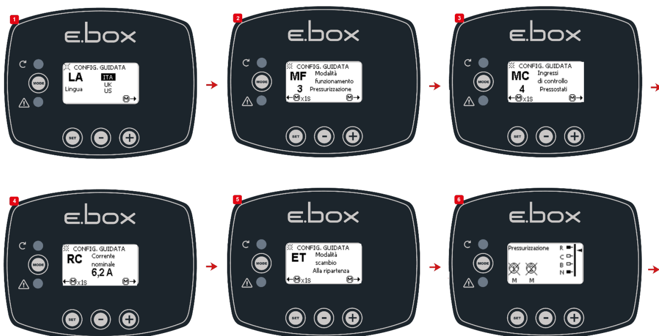
Obrázek 13: Nastavení s tlakovými spínači
