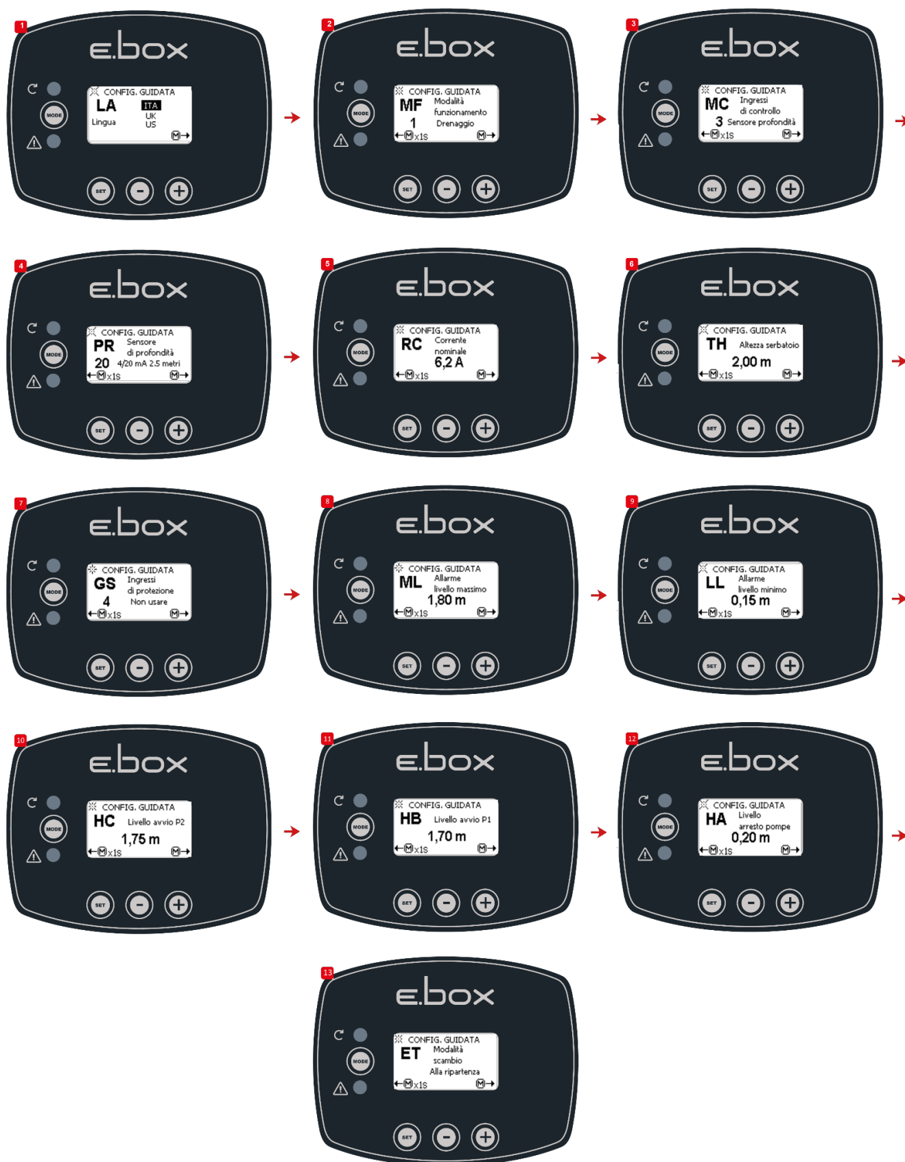
Figura 38: Configuración sólo con sensor de profundidad
