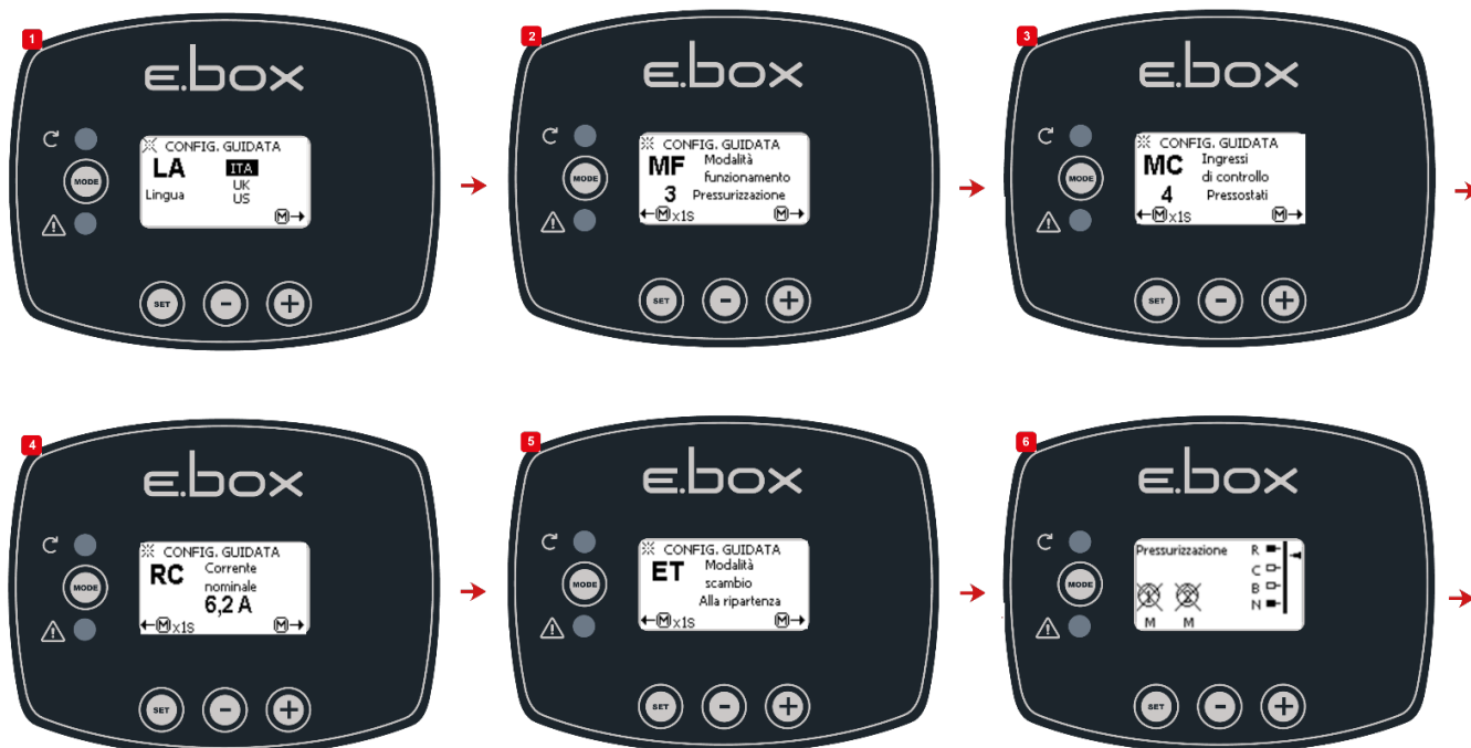
Figura 13: Configuración con presostatos
