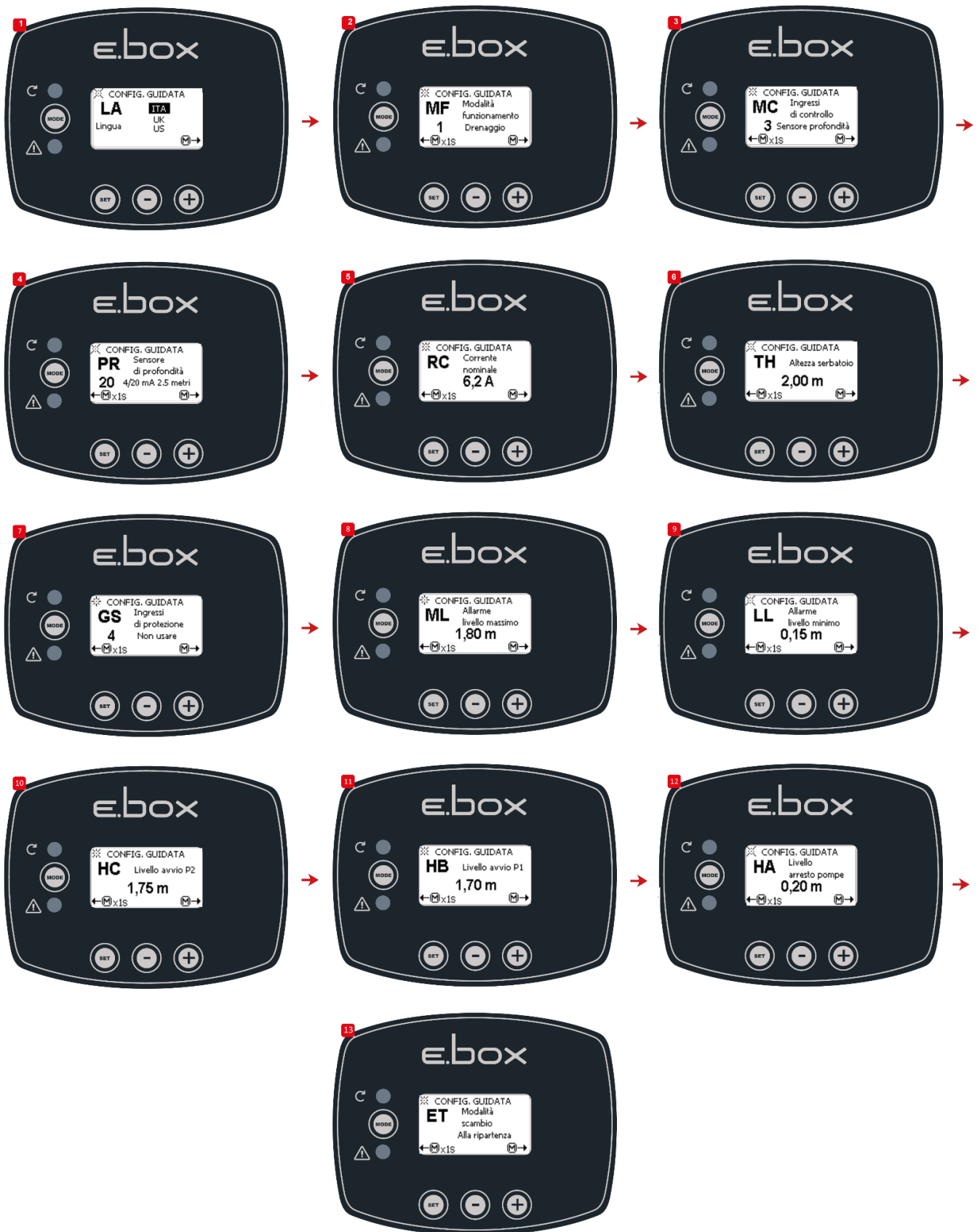
Figura 38: Configurazione con solo sensore di profondità
