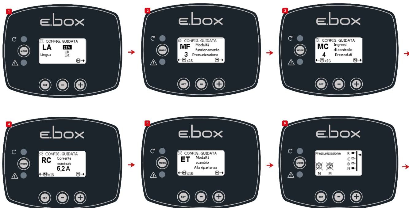
Rysunek 13: Konfiguracja za pomocą przełączników ciśnienia
