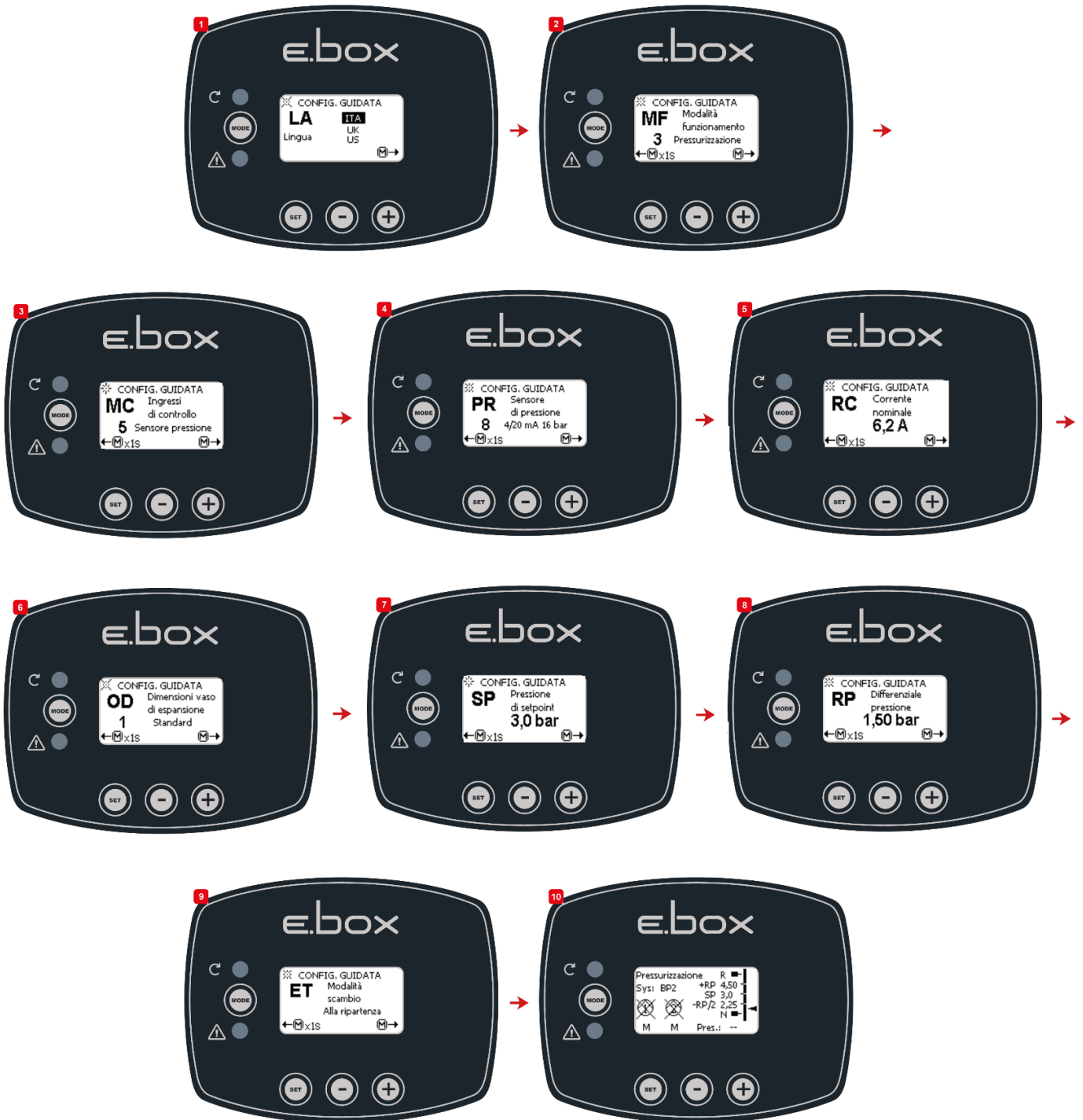
Figura 12: Configuración con sensor de presión
