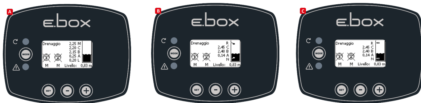
Obrázek 39: Stav systému při nastavení: A pouze s hloubkovým čidlem, B: hloubkové čidlo a plováky, C hloubkové čidlo a hladinová čidla
