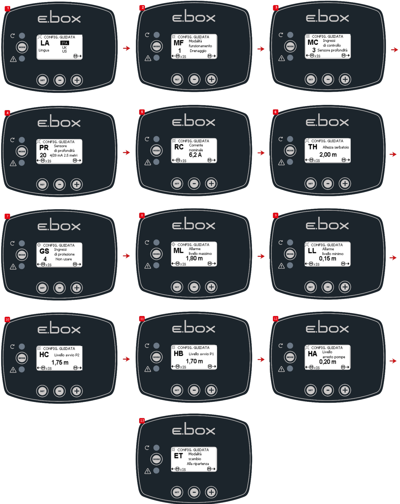
الشكل 38. التهيئة باستخدام مستشعر العمق فقط
