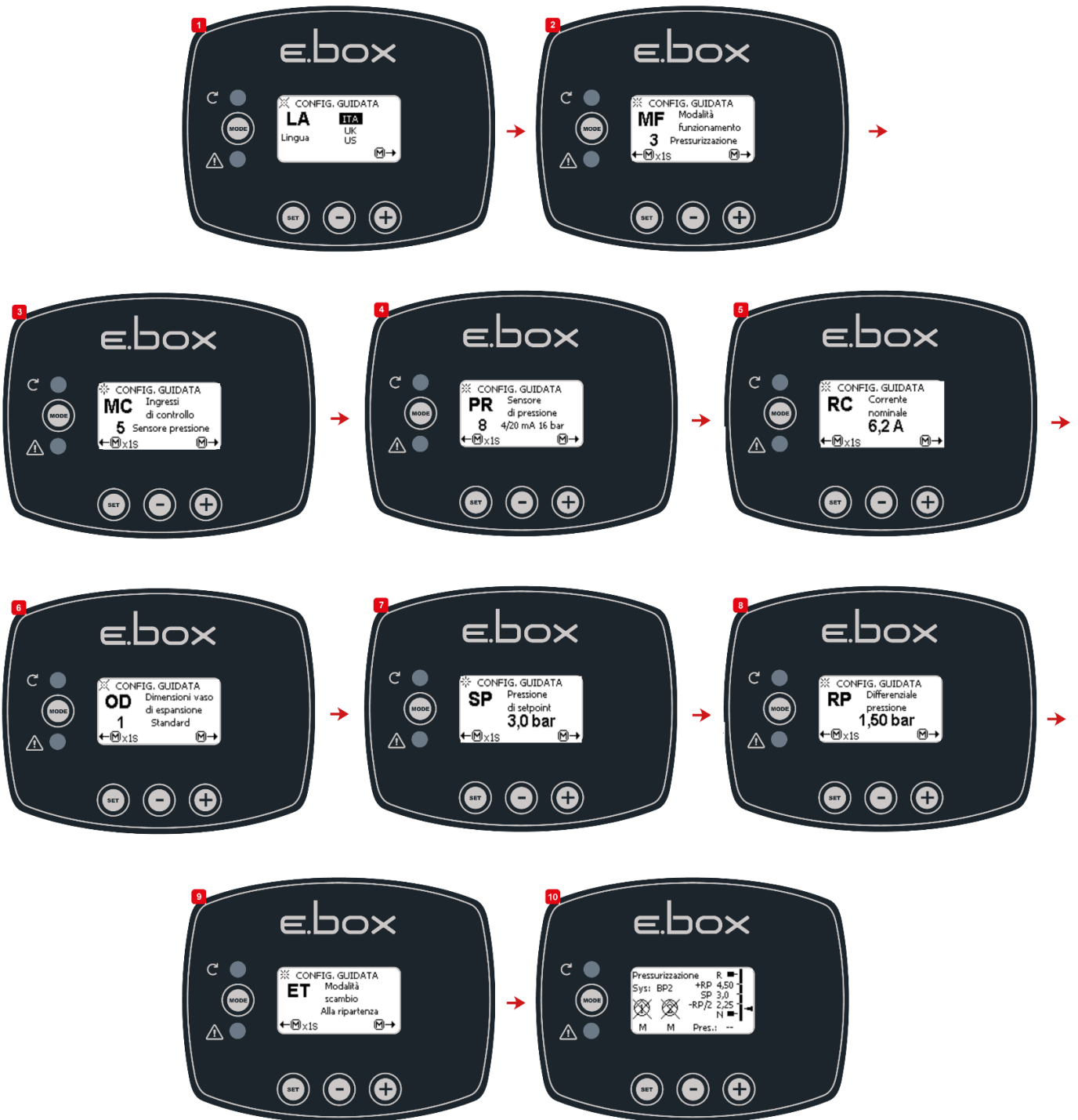
الشكل 12: التهيئة باستخدام مستشعر الضغط
