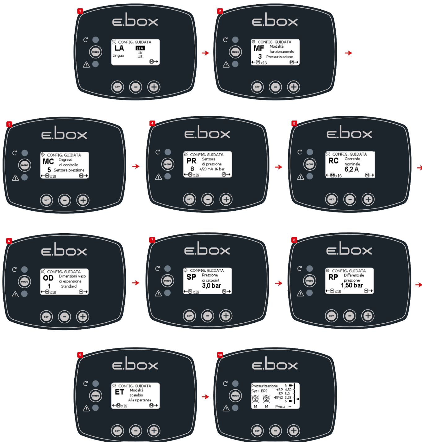
Obrázek 12: Nastavení s tlakovým čidlem
