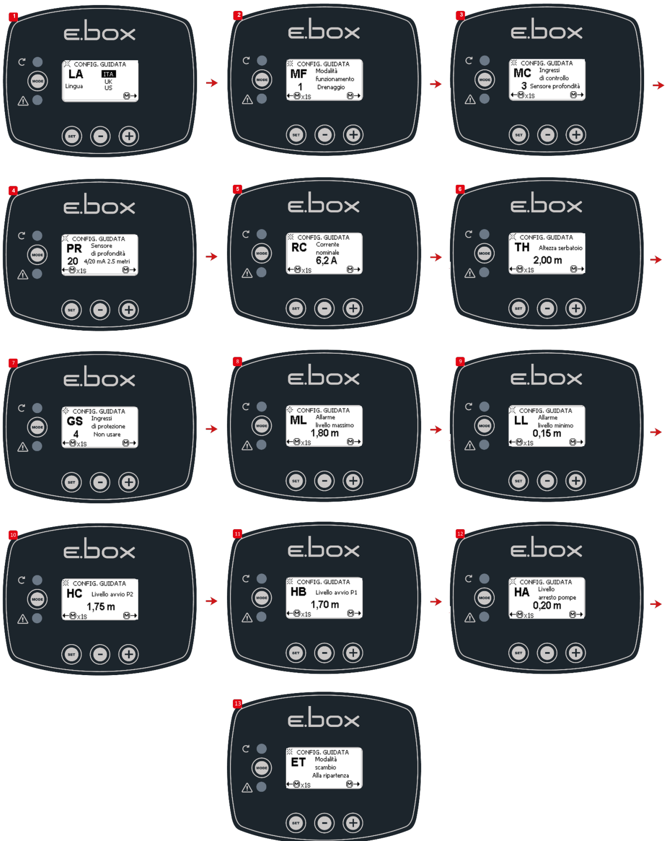
Abbeelding 38: Configuratie met alleen dieptesensor
