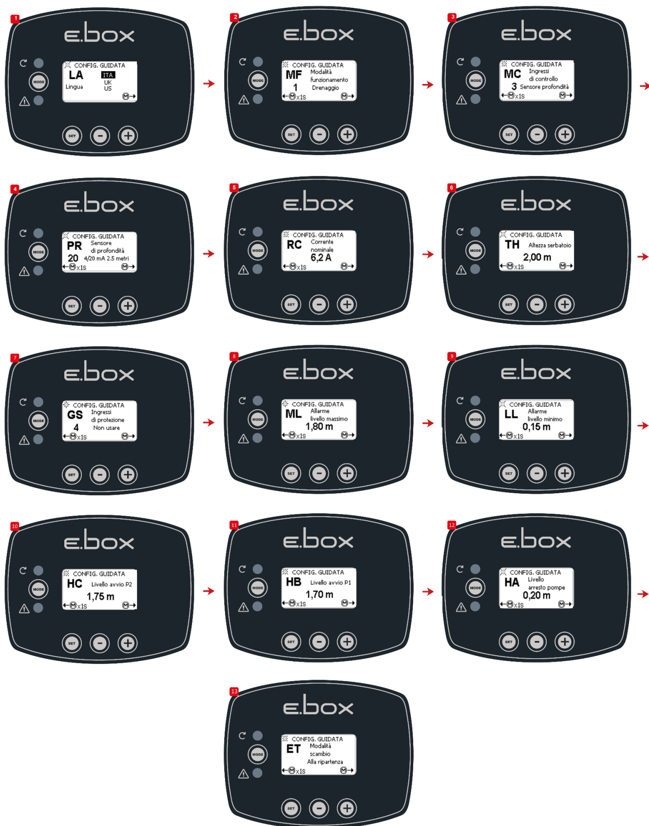
Figura 38: Configurare doar cu senzor de presiune
