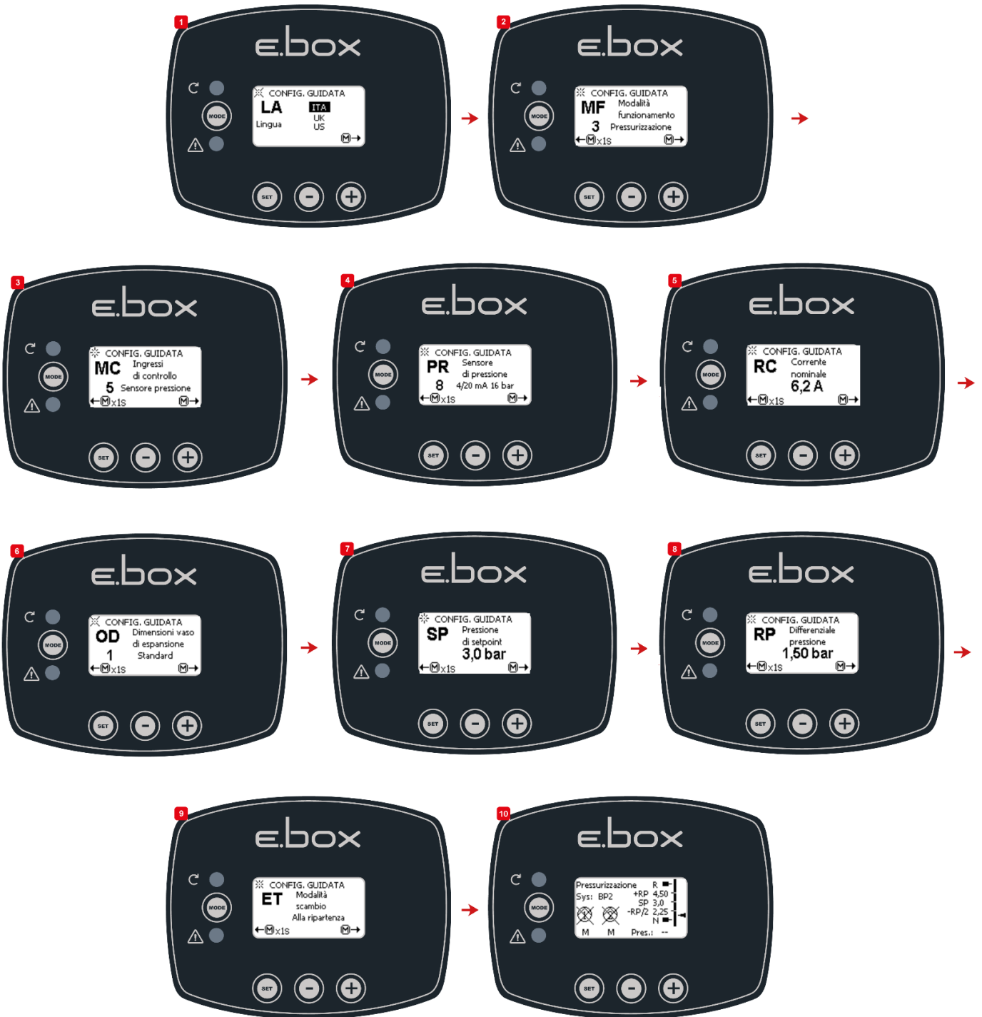
Afbeelding 12: Configuratie met druksensor
