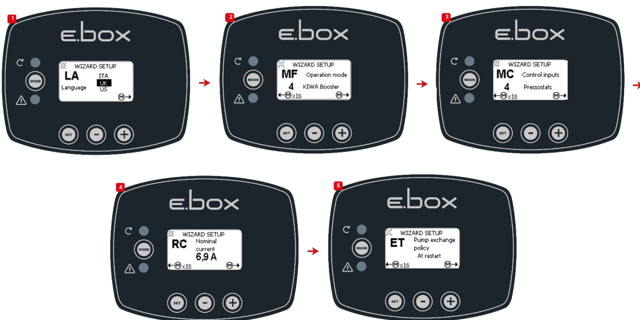
Rysunek 49: Konfiguracja KIWA za pomocą przełączników ciśnienia
