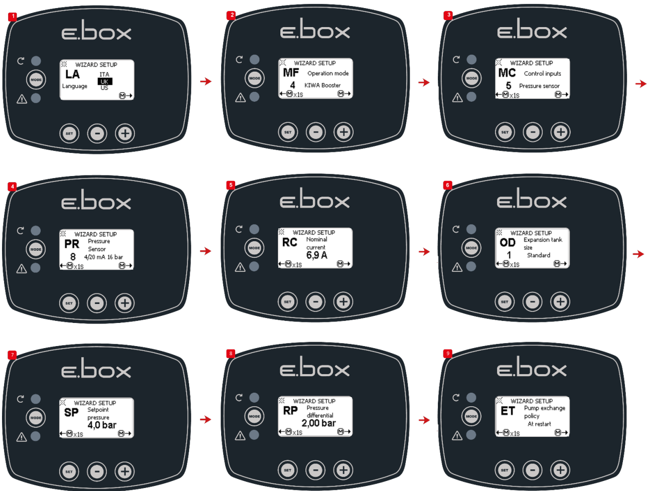
Figura 48: Presurización KIWA con sensor de presión
