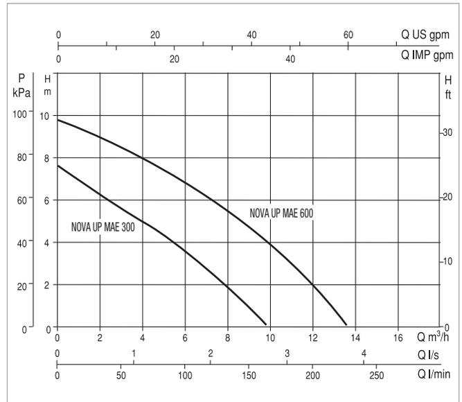
Le curve di prestazione sono basate su valori di viscosità cinematica = 1 mm<sup>2</sup>/s e densità pari a 1000 kg/m<sup>3</sup>. Tolleranza delle curve secondo ISO9906.
