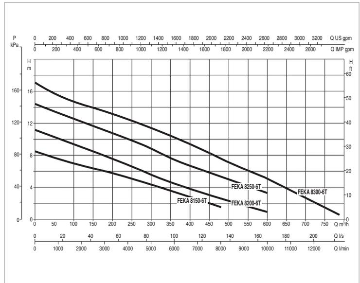
Le curve di prestazione sono basate su valori di viscosità cinematica = 1 mm<sup>2</sup>/s e densità pari a 1000 kg/m<sup>3</sup>. Tolleranza delle curve secondo ISO9906.
