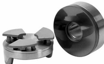
Gruppo reggispinta di tipo Kingsbury composto da ralla in carbone e pattini oscillanti in acciaio inox ad altissima resistenza lavorati da Tesla con processo di lappatura sferica
