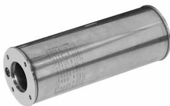
Statore incapsulato con camicia esterna in AISI 304L e flange con trattamento anticorrosione. Lo statore è a 24 cave per una maggiore elasticità e regolarità di funzionamento; conduttori in rame isolato con doppio smalto in Classe H.
