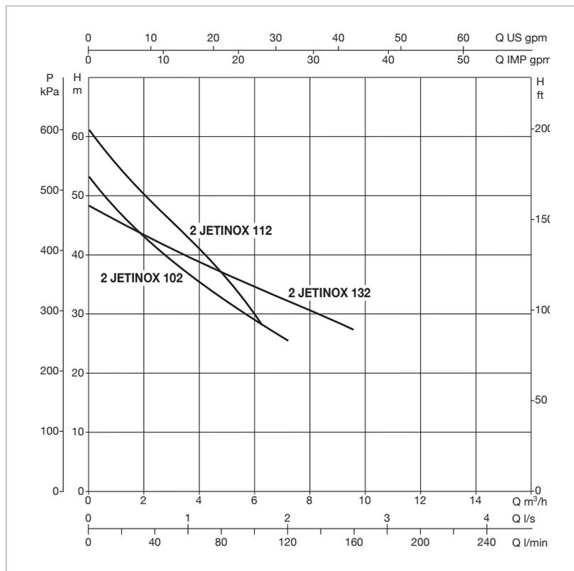
Le curve di prestazione sono basate su valori di viscosità cinematica = 1 mm<sup>2</sup>/s e densità pari a 1000 kg/m<sup>3</sup>. Tolleranza delle curve secondo ISO9906. **Prestazioni complessive riferite a DUE pompe funzionanti contemporaneamente.** Le prestazioni di gruppi con pompe più piccole (es. 2JETINOX 92) si ottengono con la semplice taratura del modulo Active Driver.
